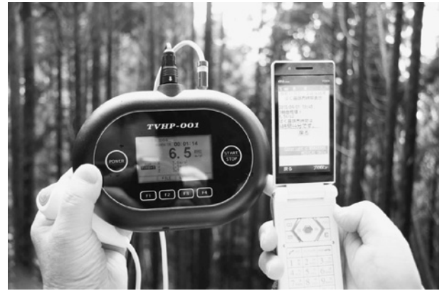
図11 振動加速度測定値の基地局への送信と分析結果の基地局からの受信
