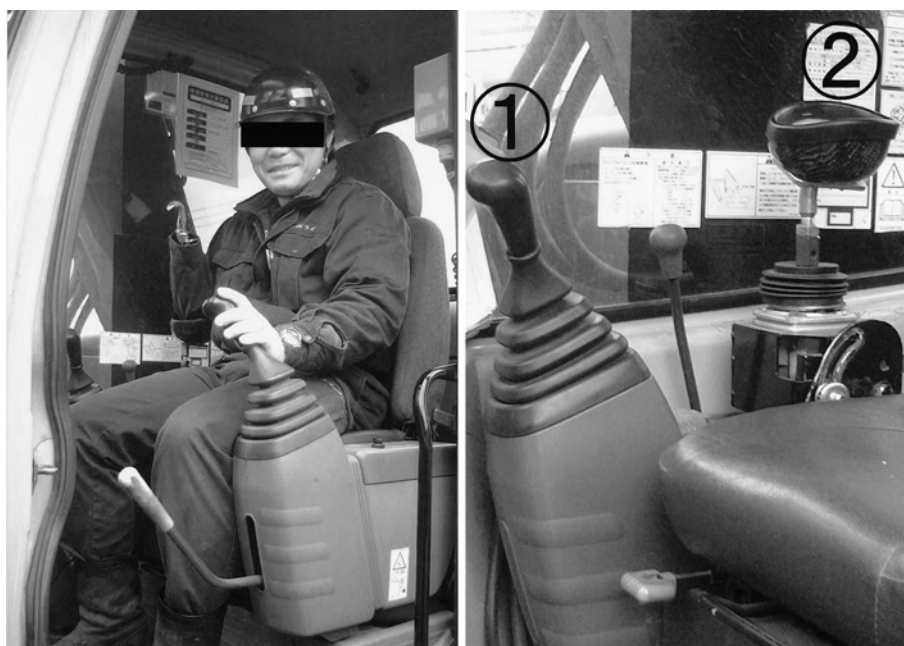
図8 改造後操縦席（左）カップ付操作レバー（右）①⇔②は切り替え可能
